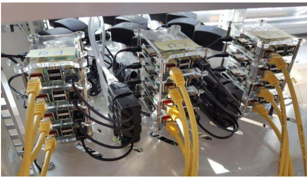
BILD 5. Traffic Generator aus Raspberry Pis
